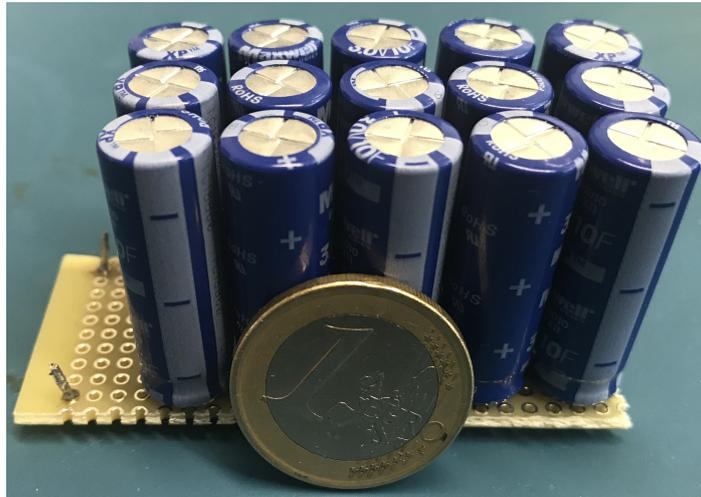
Abbildung 6.3: Aufbau des C-Blocks des 40 V-Direkt-Betriebs
